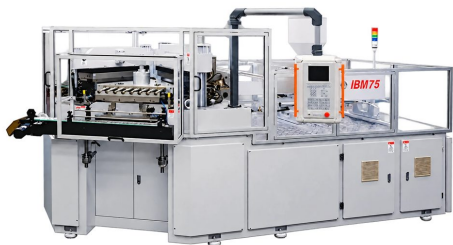
Formsprutningsblåsmaskin IBM75 - maskinvy
